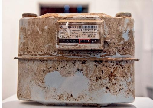
*Durch die Flut wurde auch das Gasnetz im Ahrtal weitgehend zerstört. Der Zählerstand auf dem Gaszähler markiert den Zeitpunkt, an dem das Gebäude, in dem der Zähler montiert war, vom Gasnetz abgerissen wurde.*
