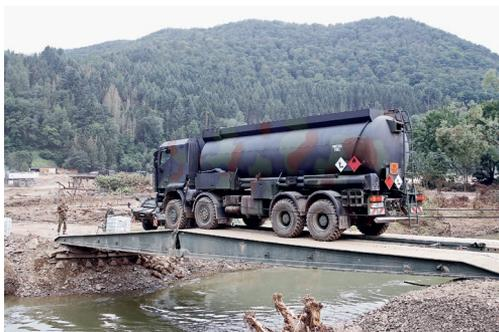
*Ein Betriebsstoff-LKW überquert die Panzerschnellbrücke.*
