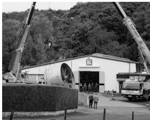
Verladung einer Turbine zur Auslieferung
